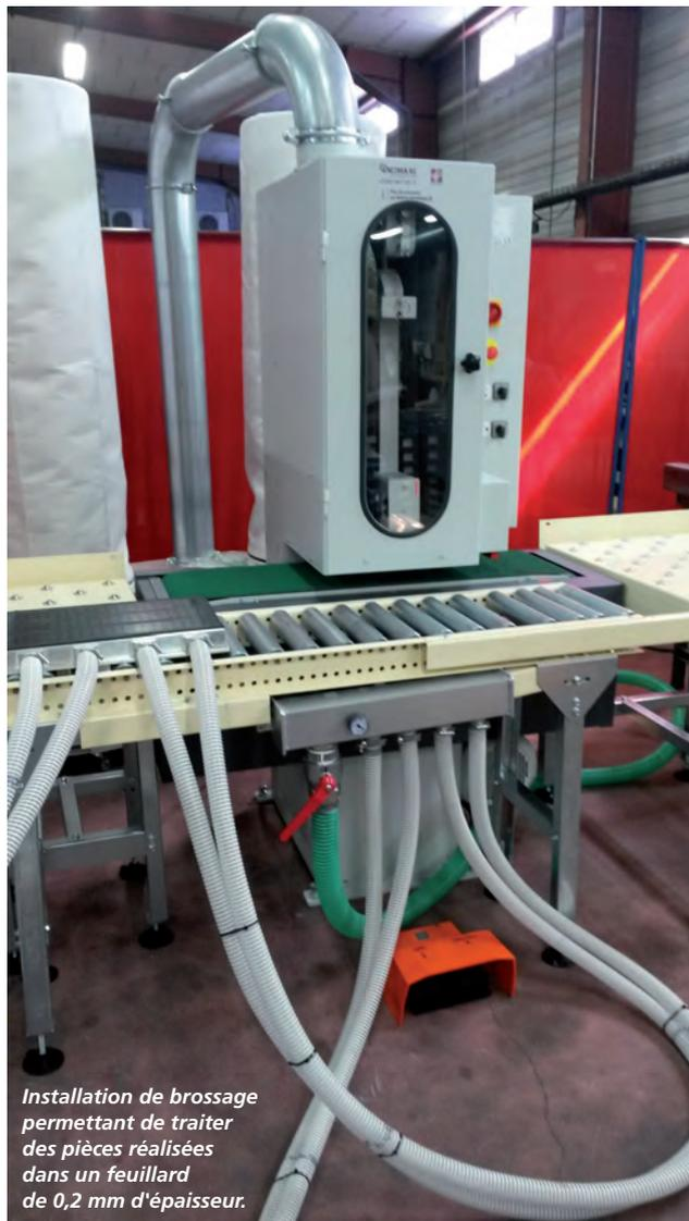
Installation de brossage permettant de traiter des pièces réalisées dans un feuillard de 0,2 mm d'épaisseur.
